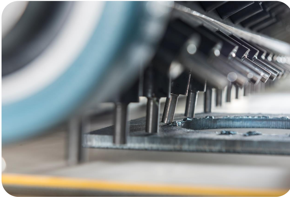
Ansamblul arborelui cu pini pe o glisiera,, pentru o schimbare sau intretinere usoara
