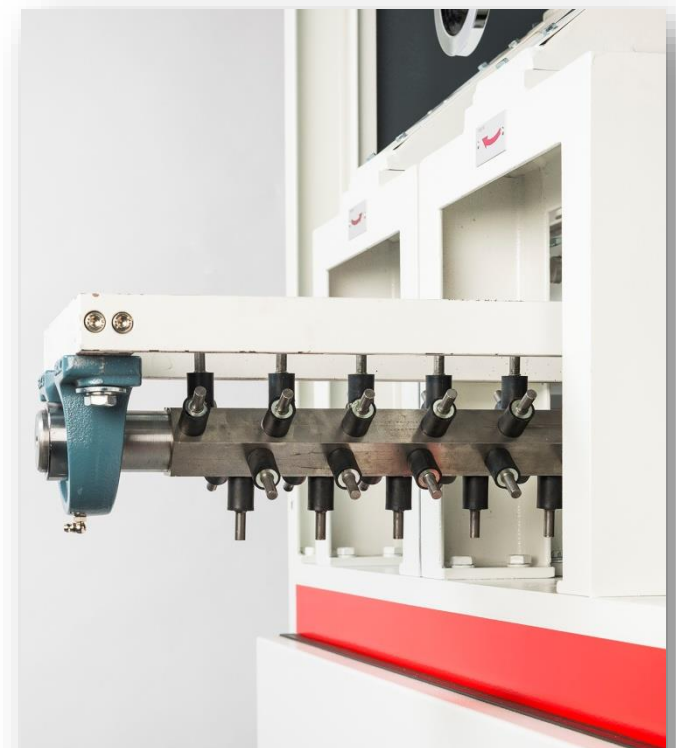
Ansamblul arborelui cu pini pe o glisiera,, pentru o schimbare sau intretinere usoara
