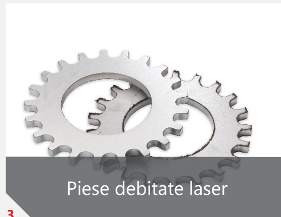
Piese cu oxid de la debitarea laser CO 2
